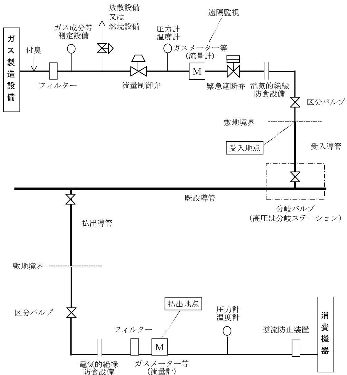
注：上図は概念図として参考に図示したものです。ガス製造形態や受入及び派出地点の位置等による差異が大きいため、詳細は個別に協議させていただきます。
